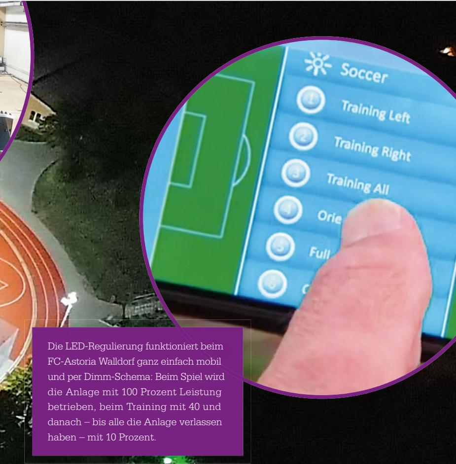
Die LED-Regulierung funktioniert beim FC-Astoria Walldorf ganz einfach mobil und per Dimm-Schema: Beim Spiel wird die Anlage mit 100 Prozent Leistung betrieben, beim Training mit 40 und danach – bis alle die Anlage verlassen haben – mit 10 Prozent.
